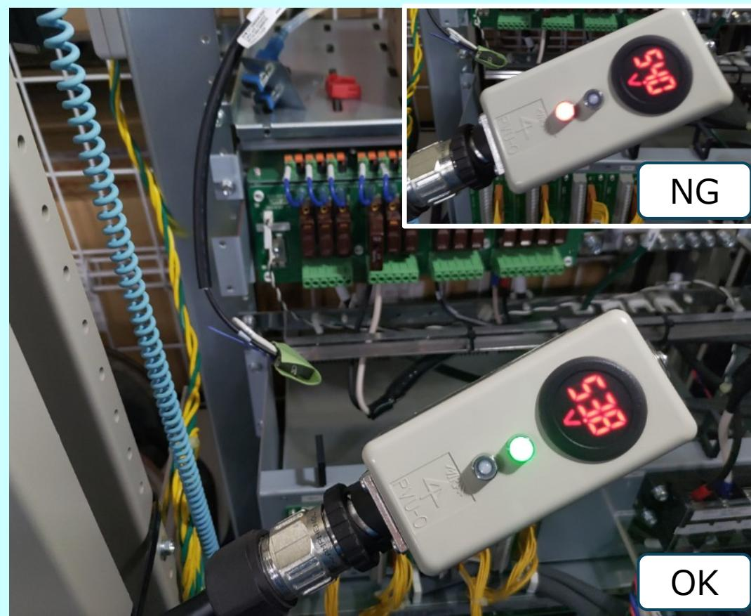
実際に無線機で使用されているコネクタを用い、決まった方向にしか挿入できない仕様にすることで安全に極性を確認することが出来る。逆接続の場合は赤色LEDが表示される。
