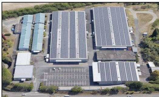
屋上設置により、直射日光遮断効果による夏場空調電力の抑制効果が期待できます。
